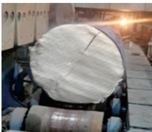
图8 45钢φ1 200 mm圆坯铸坯端部保温罩
